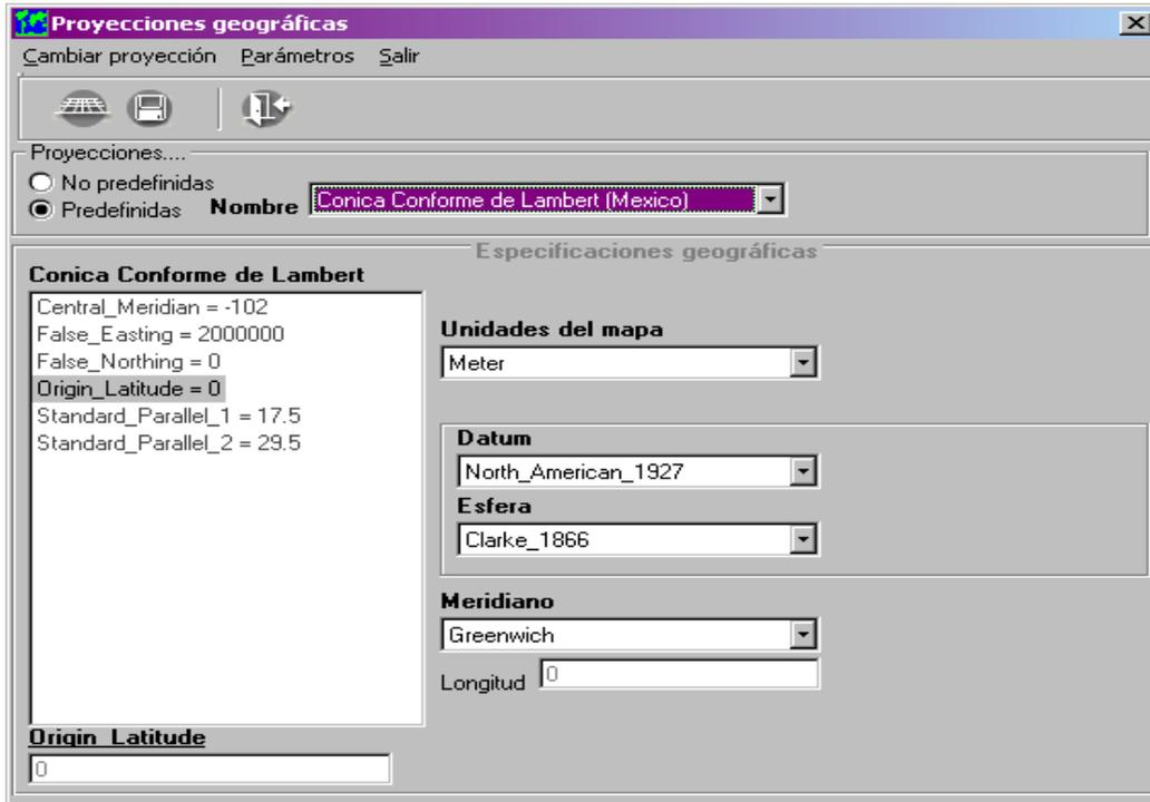
En la figura se muestra la proyección Cónica conforme de Lambert
