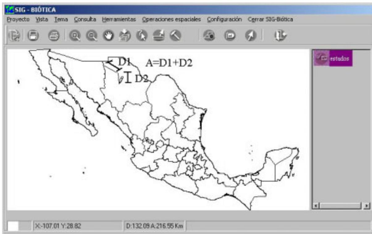
Se muestra el cálculo de distancia de una línea con dos segmentos
