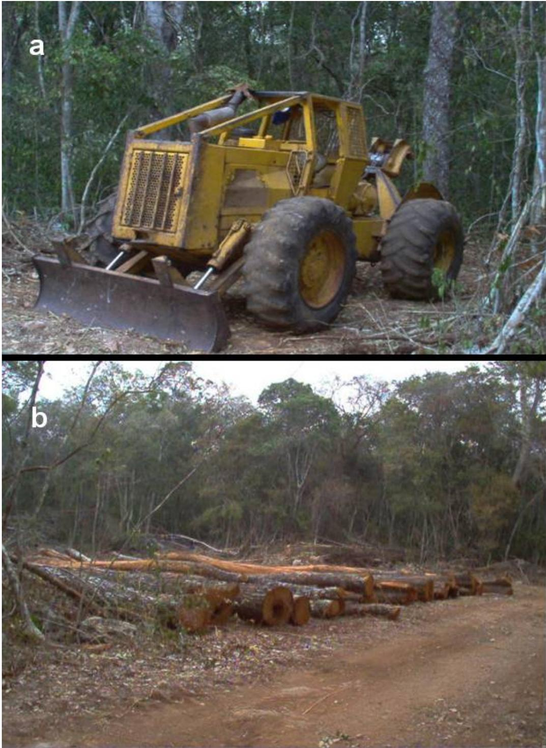
Figura 11. El uso de vehículos pesados (a) es una actividad común durante la apertura de caminos y arrastre de troncos a las bacadillas (b), y posteriormente al aserradero. (Fotos: mayo – 2005, GGG).
