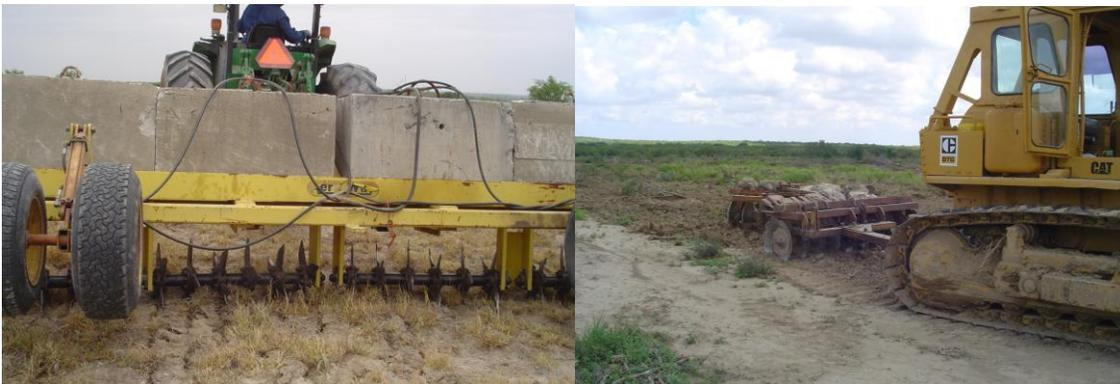
Figura 4. Aireación de pastas con rodillo y con rastra.
