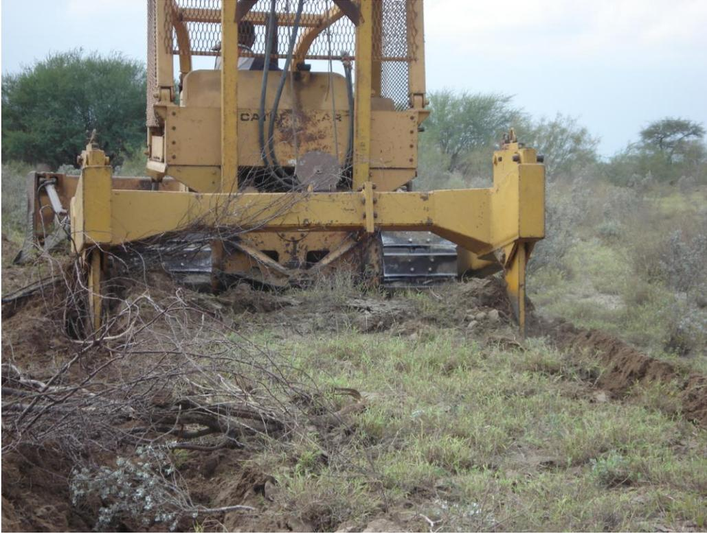
Figura 3. Tractor oruga realizando la práctica de conservación de suelos de rocoteo.
