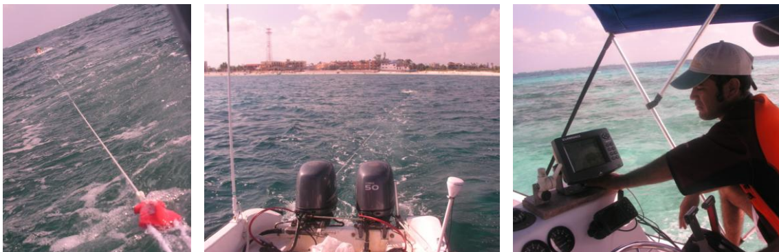
Ilustración 1: Arrastres de un observador (izquierda y centro). Toma de datos batimétricos con una ecosonda Lowrance LCX-17M (derecha). (Fotos: Albert Franquesa Rinos).
