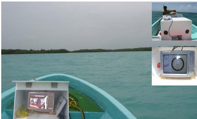
Figura 1. Ecosonda y embarcación con motor fuera de borda utilizados durante los recorridos para obtención de datos de profundidad georeferenciados. (Foto L. Carrillo, fotos recuadros H. Hernández).
