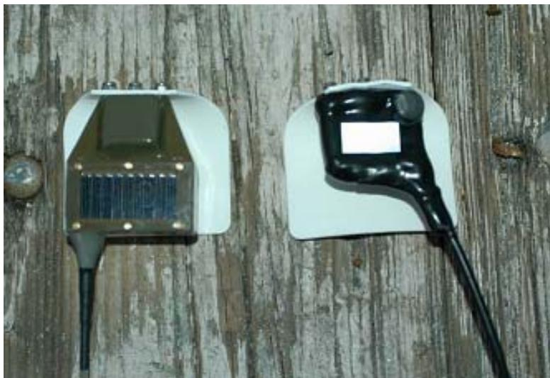
Figura 16. A la derecha transmisor satelital con GPS y a la izquierda transmisor convencional de radio telemetría
