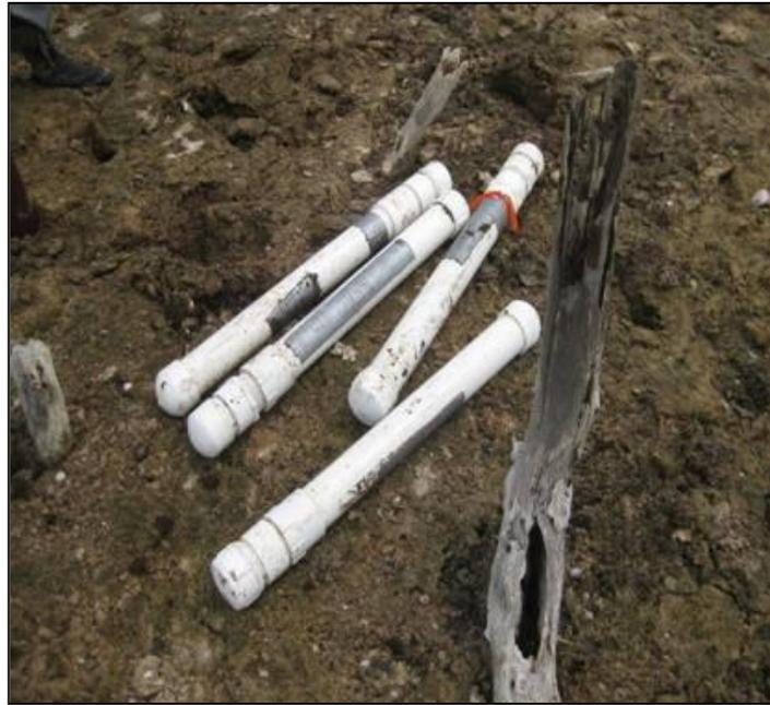
Figura 6. Toma de núcleos para la determinación de las características del sedimento.
