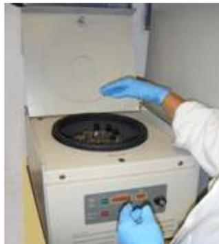
Figura 7. Colocación de tubos con muestras de clorofila-a en la centrifuga.
