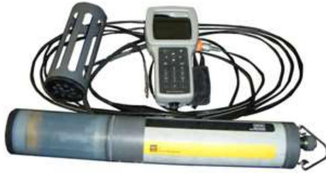
Figura 3. Sonda multiparámetrica YSI 6600.
