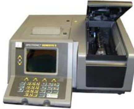
Figura 8. Espectrofotómetro donde se realiza la lectura de absorbancias.
