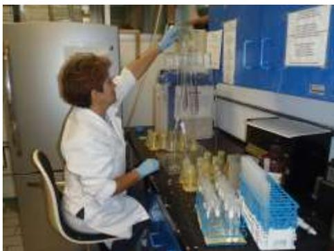
Figura 5. Método de reducción a nitritos a través de una columna de cadmio-cobre.
