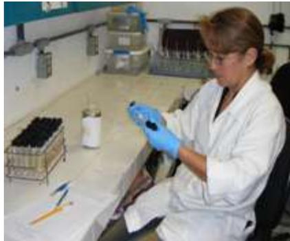
Figura 6. Colocación de filtros de ester celulosa con acetona al 90% para la extracción de la clorofila-a.
