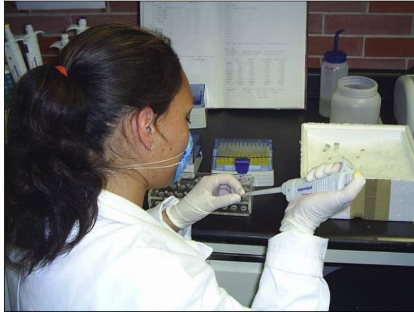
Figura 2. Preparando las muestras de ADN para su amplificación en el termociclador por medio de la Reacción en cadena de la Polimerasa (PCR), en el Laboratorio de Biología Molecular de la Colección Nacional de Mamíferos.
