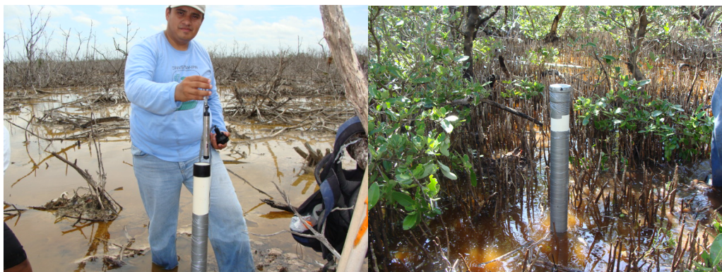
Figura 7. Instalación de medidores electrónicos de nivel de agua.
