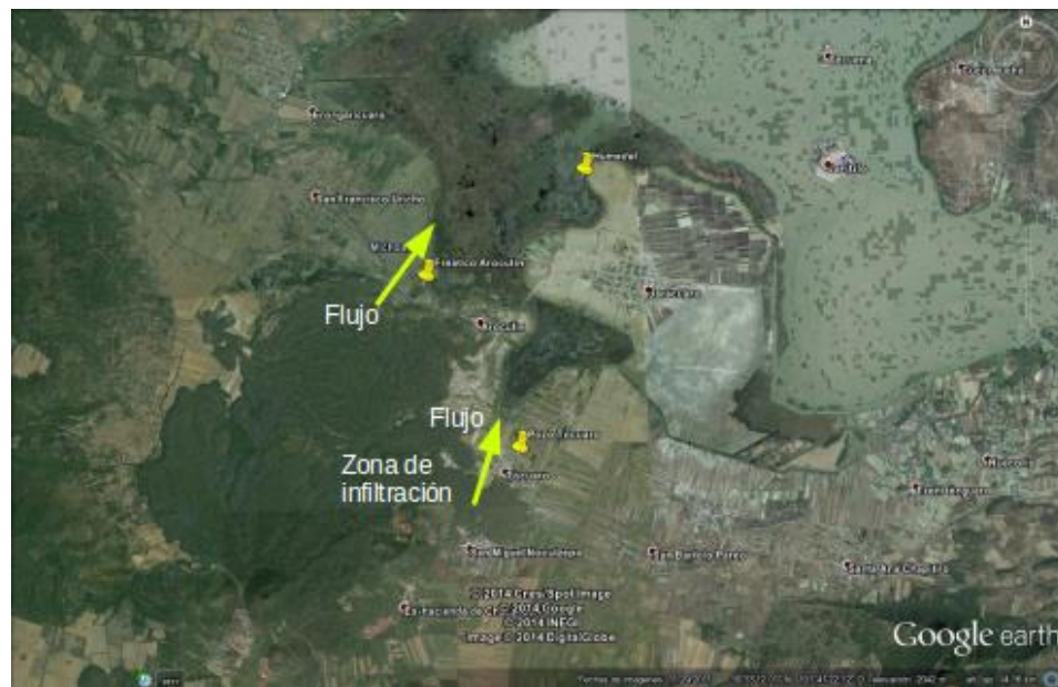
Figura 8.8. Ubicación de los sitios de monitoreo piezométrico y dirección del flujo subsuperficial.
