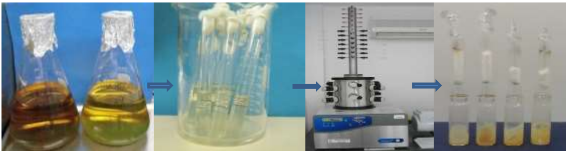
Figura 10. Procedimiento de liofilización: soluciones crioprotectoras, ampolletas en preparación, Liofilizadora, ampolletas terminadas y selladas.
