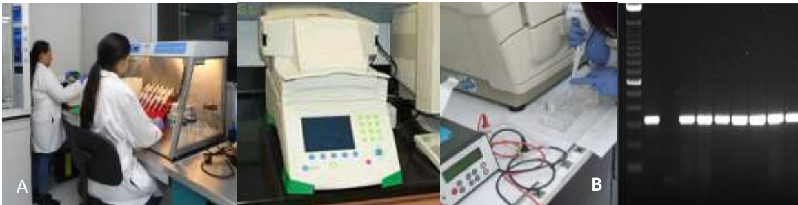
Figura 8. Técnica de PCR. A) Preparación de reacción, termociclador, B) carga de geles y visualización de fragmentos de ADN amplificado en gel de agarosa.
