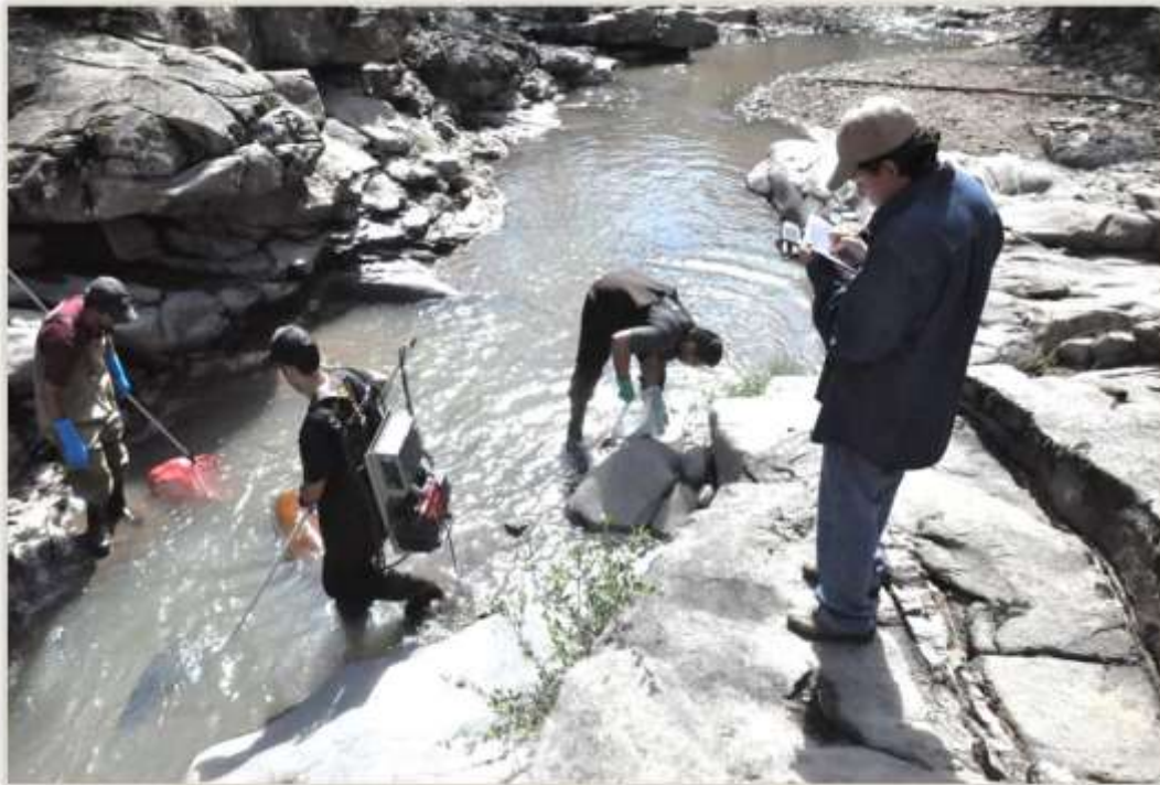
Fig. 11. Proceso de captura de truchas nativas con equipo de electropesca (Smith-Root 15-D POW).y registro de datos en la SMO.
