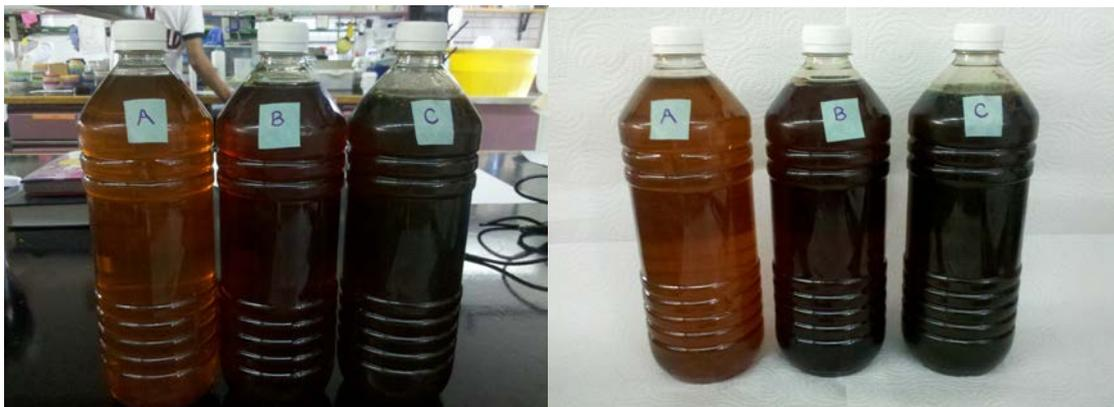
Figuras 5 y 6. Muestras de referencia tomadas para la escala de colores.
