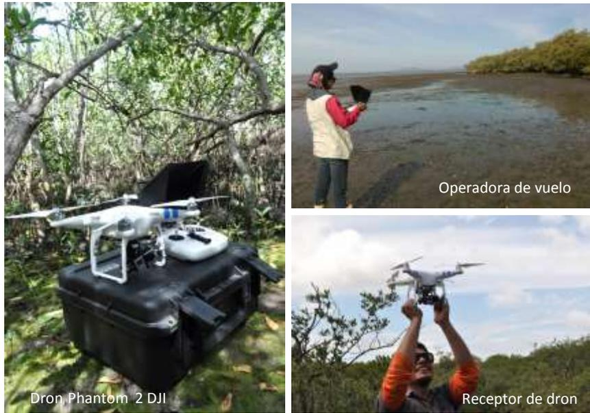
Figura 10. Detalle del dron utilizado para realizar fotografía aérea.
