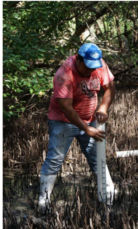
Figura 7. Instalación de piezómetros en las UM
