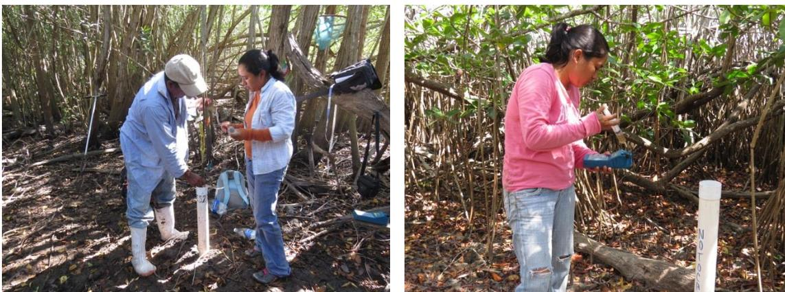
Figura 10. Monitoreo de parámetros fisicoquímicos con ayuda de los piezómetros.
