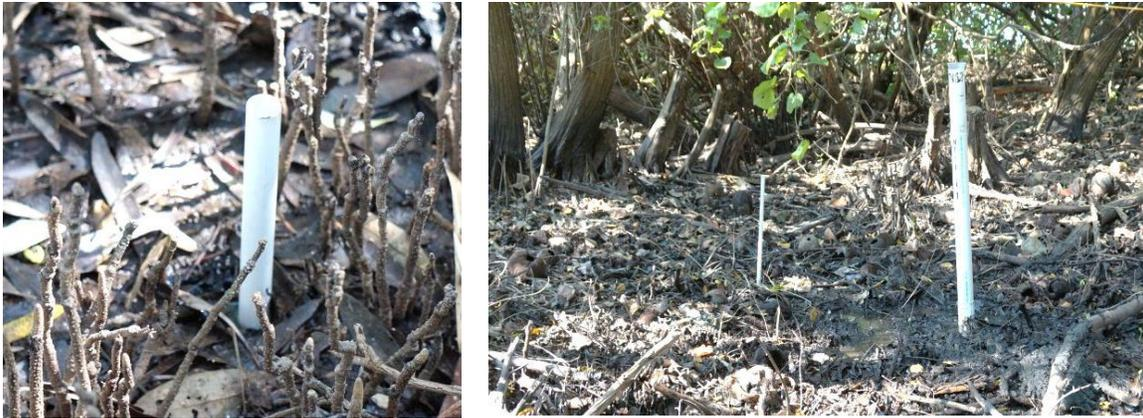
Figura 12. Monitoreo de tubos de PVC para Acreción/subsidencia.
