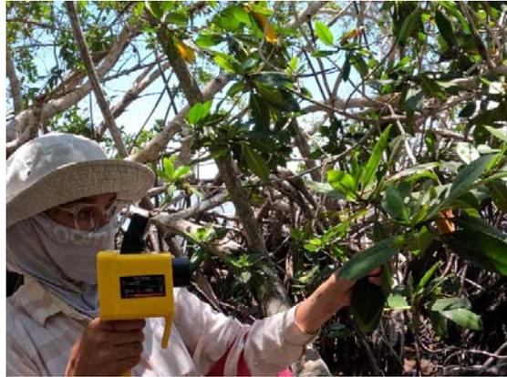
Figura 36. Medición en manglares del Índice de Vegetación de Diferencia Normalizada con el instrumento Fieldscout CM 1000.
