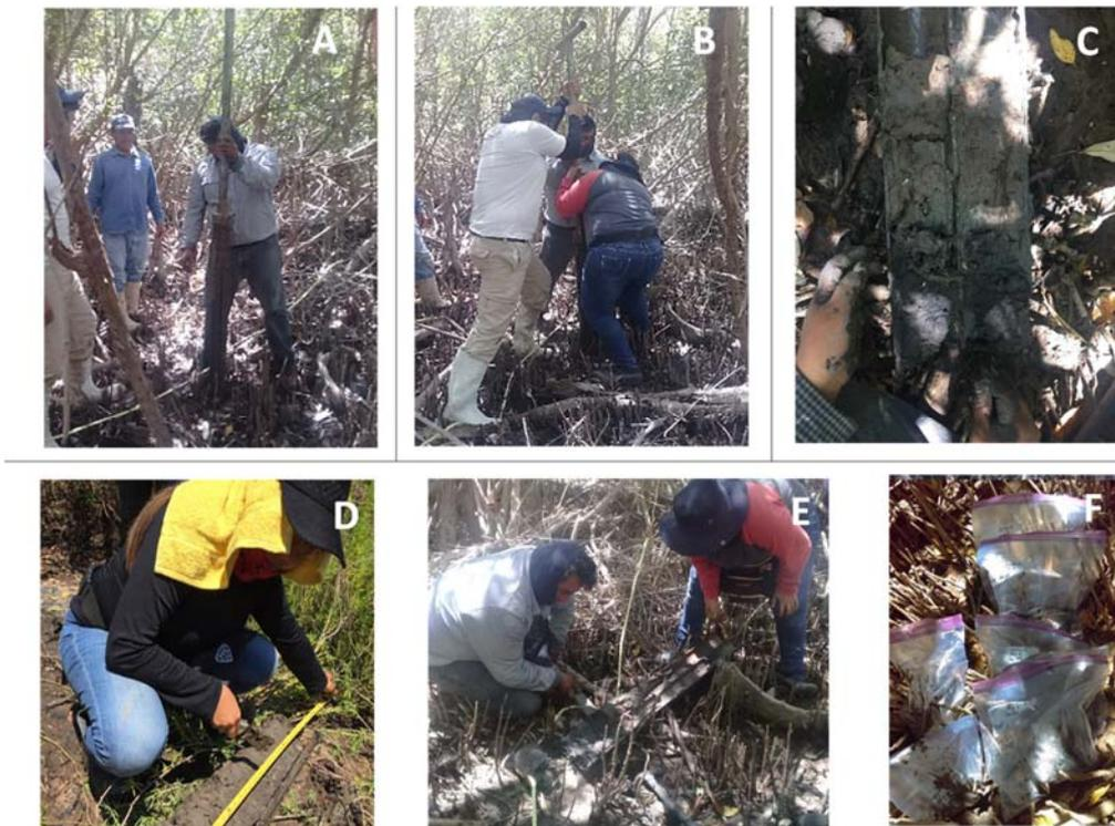
Figura 6. Recolección de muestras: A) Ubicación y preparación para toma de muestras; B) Nucleador introducido en toda su profundidad; C) Extracción del núcleo; D) Limpieza superficial de la muestra y medición de los intervalos de profundidad; E) Extracción de las muestras a cada intervalo; F) Muestra embolsada lista para ser enviada a laboratorio.
