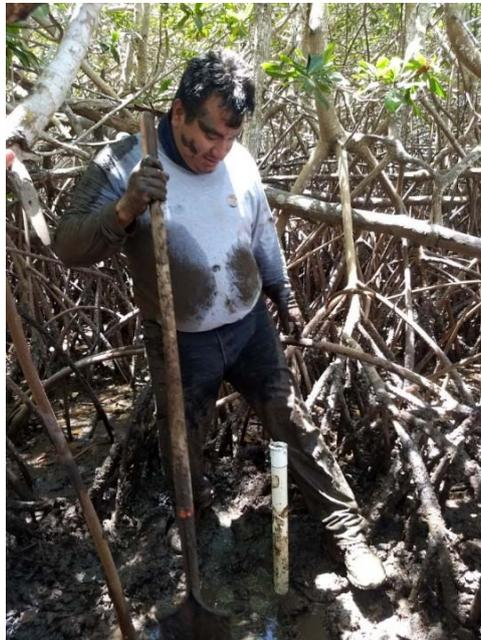
Figura 9. Instalación de uno de los piezómetros dentro de la parcela 20 x 20 m.
