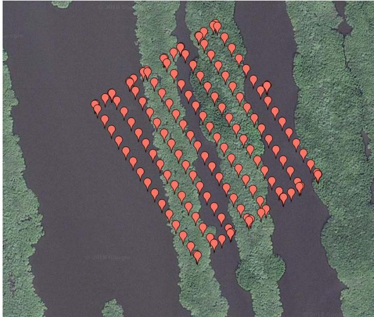
Figura 3. Ejemplo de área barrida realizada con Dron Phantom 4 para realizar fotografías verticales georreferenciadas. Parcela ID 9.
