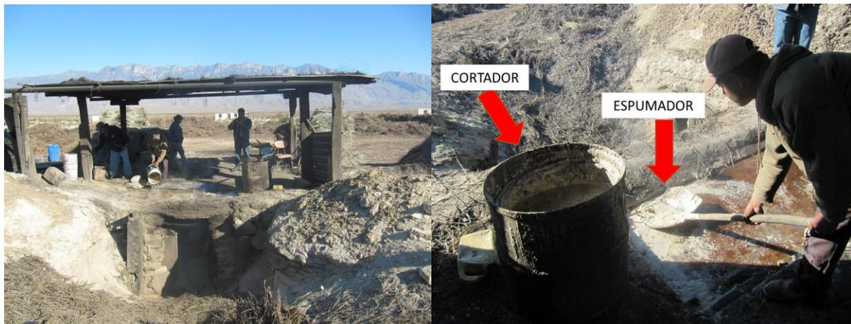
**Figura 3.-** Estructura de una paila (izquierda). Se muestra el espumador y el cortador donde se coloca el cerote aún líquido (derecha). Fotos: Laura Hernández Rosas.
