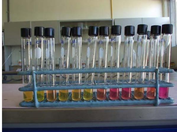
*Fig 5. Prueba de hidrólisis de urea, el color rosa es una prueba positiva.*
