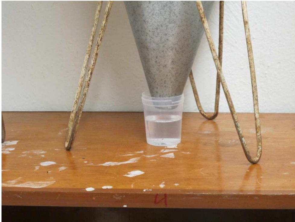
Figura 17. Frasco colector debajo del embudo de Berlese.
