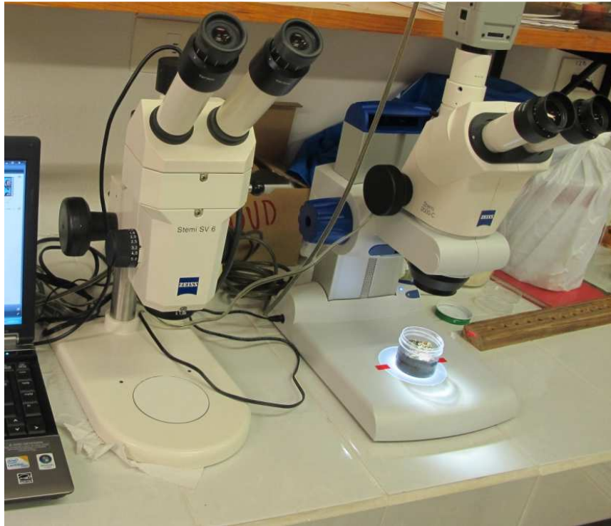
Figura 18. Microscopio estereoscópico en el que se cuantificaron y clasificaron los organismos.
