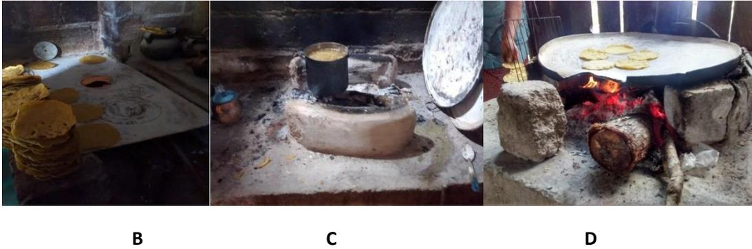
Figura B. Fogón tipo justa en Yaluma. Figura C. Base circular sin chimenea en Yaluma. Figura D. Fogón circular con chimenea en Campo Santiago.
